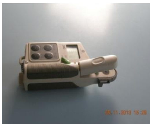
Fig. 10. Aparat pentru măsurarea valorilor SPAD (INCDCSZ Brașov)
