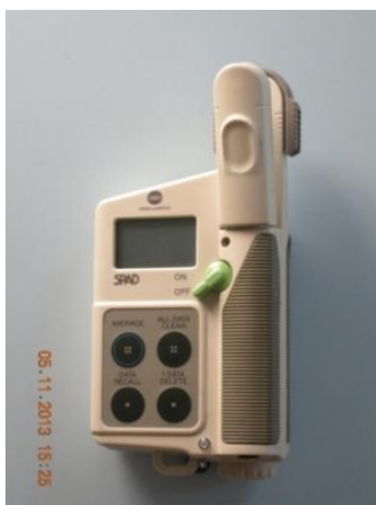
Fig. 10. Aparat pentru măsurarea valorilor SPAD (INCDCSZ Brașov)
