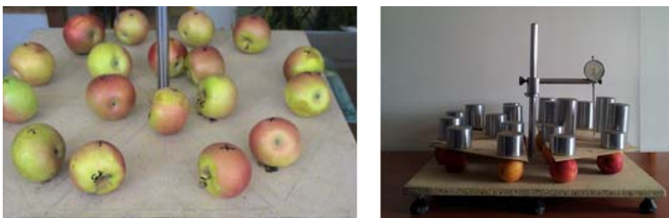
Fig. 49. Aranjarea merelor pe aparatură A.M.D. , înainte și după aplicarea greutăților.
