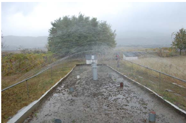
Fig. 69. Instalația de ploaie artificială utilizată pe parcela de scurgere P2 (Foto: G. MINEA).
