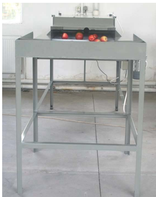
Fig. 64. Instalație de decontaminare a suprafețelor exterioare ale produselor horticoale – IDPH.
