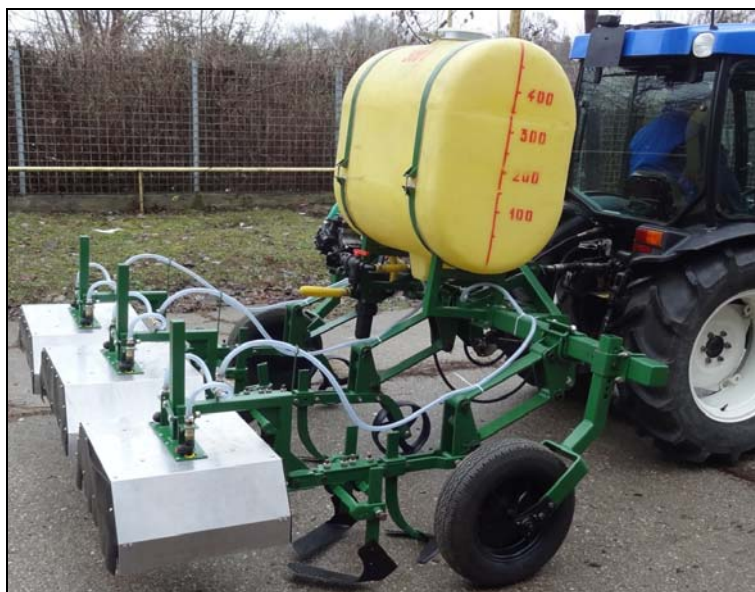
Fig. 68. Echipament de prășit și erbicidat cu precizie în benzi – MEP.
