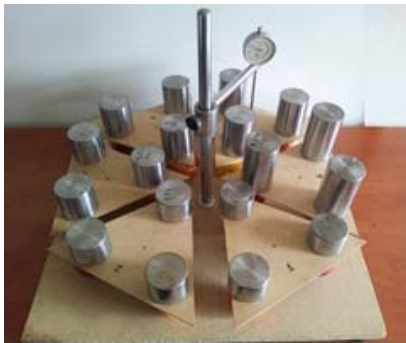
Fig. 51. Vederi ale aparatului pentru măsurarea deformației fructelor la solicitări statice.
