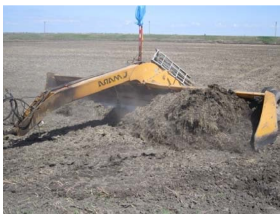
Fig. 33. Utilaj terasier cu dispozitiv de ghidaj laser.
