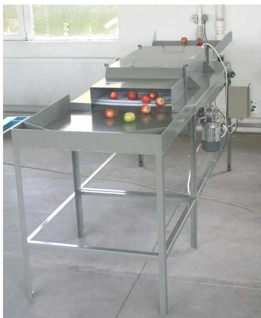
Fig. 63. Instalație de decontaminare a suprafețelor exterioare ale produselor horticoale – IDPH.
