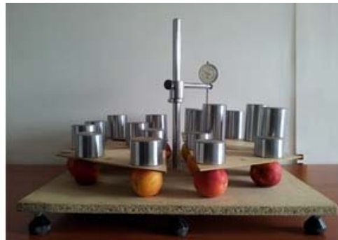
Fig. 51. Vederi ale aparatului pentru măsurarea deformației fructelor la solicitări statice.
