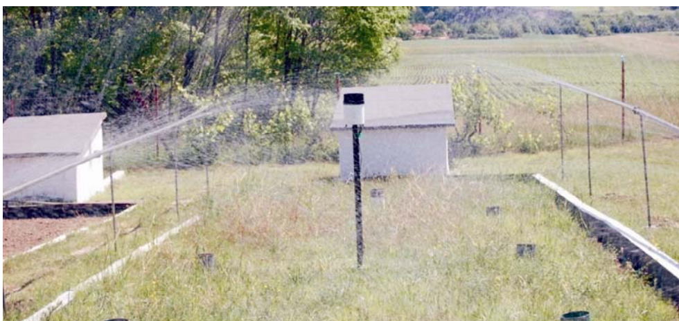
Fig. 122. Parcelă experimentală folosită pentru studiul scurgerii de suprafață, în condiții de sol acoperit cu graminee perene.
