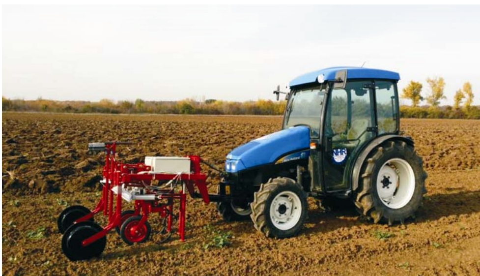
Fig. 113. Echipament tehnic multifuncțional de întreținere mecanică pe rând și între plante a culturilor agricole și a sistemului inteligent de control – EIP .
