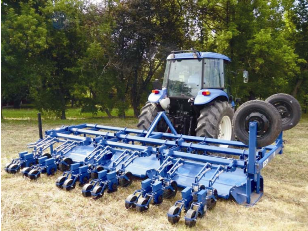
Fig. 111. Echipament tehnic pentru semănat legume bulboase și rădăcinoase concomitent cu pregătirea și modelarea solului – ESM .
