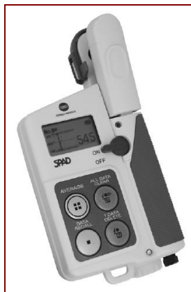
Fig. 9. SPAD 502DL Plus Chlorophyll Meter
