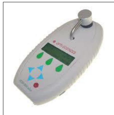
Fig. 10. ACM-200 Anthocyanin Content Meter
