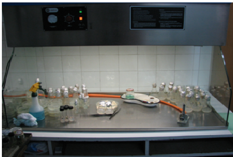
Figura nr.4. Hota cu flux laminar vertical în care sa realizat inocularea explantelor în condiții aseptice
